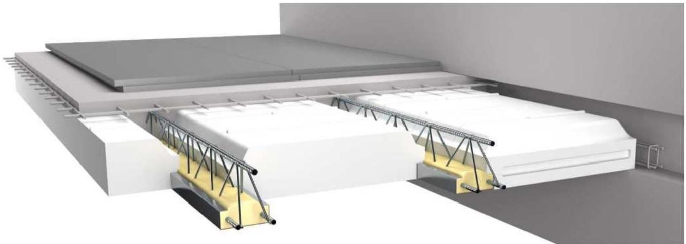
Mise en œuvre d'un **plancher isolant avec chape flottante sur vide sanitaire** avec poutrelles préfabriquées isolantes et entrevous en polystyrène de type Isoltop ou similaire complété par du béton formant la partie haute des nervures de poutrelles et la table de compression. La mise en œuvre sera conforme aux prescriptions du guide de pose, au plan de pose du fabricant et aux normes en vigueur. L'épaisseur du plancher pourra varier suivant la portée et les charges.
