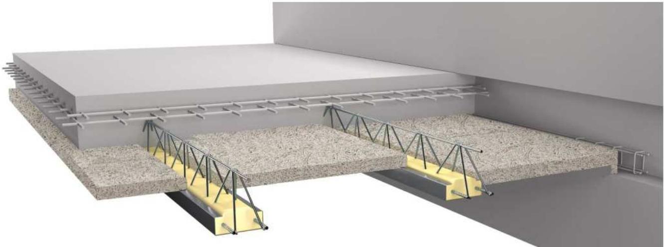
Mise en œuvre d'un plancher intermédiaire acoustique avec poutrelles préfabriquées ultra légères et entrevous de type Teknofibre Isoltop ou similaire complété par du béton formant la partie haute des nervures de poutrelles et la table de compression.
