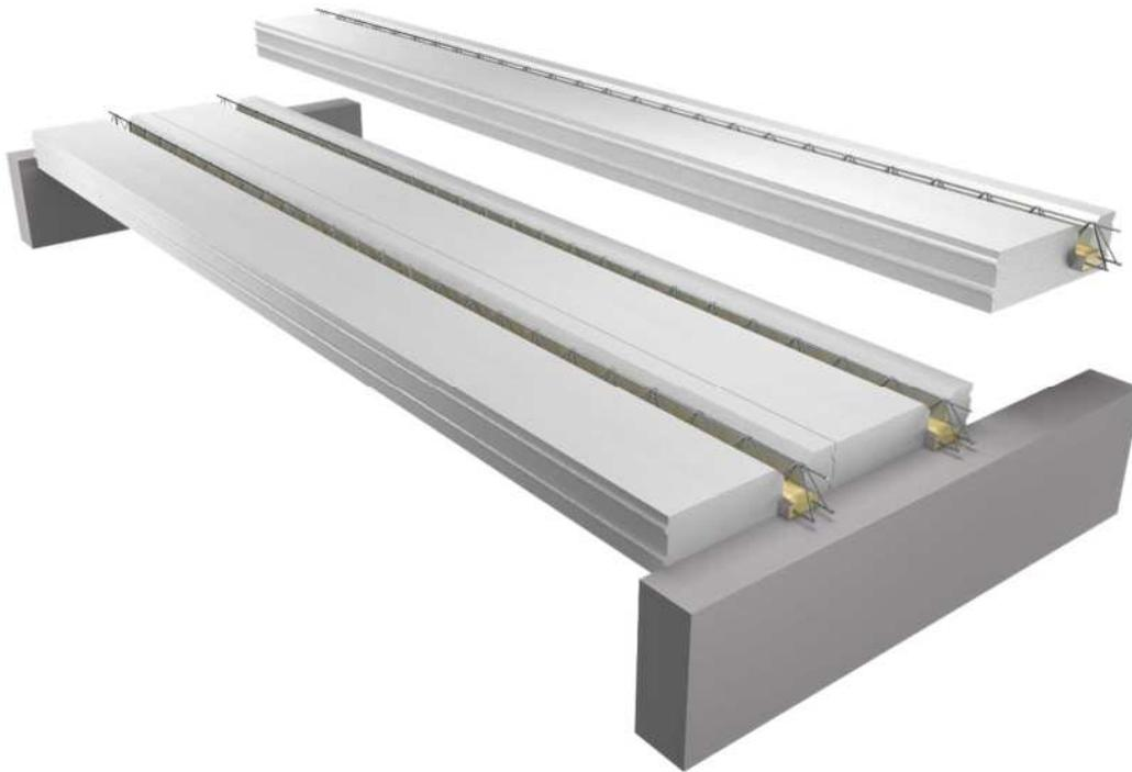
Mise en œuvre d'un **plancher isolant sur vide sanitaire avec prédalle isolante** préfabriqué en polystyrène de type Imax ou similaire complétée par du béton formant la partie haute des nervures de poutrelles et la table de compression. La mise en œuvre sera conforme aux prescriptions du guide de pose, au plan de pose du fabricant et aux normes en vigueur. L'épaisseur du plancher pourra varier suivant la portée et les charges.
