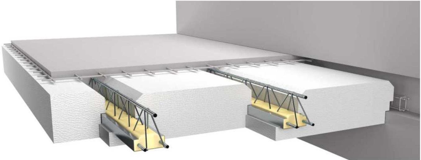
Mise en œuvre d'un **plancher isolant sur sous-sol** avec poutrelles préfabriquées isolantes et entrevous en polystyrène de type Isoltop ou similaire complété par du béton formant la partie haute des nervures de poutrelles et la table de compression. La mise en œuvre sera conforme aux prescriptions du guide de pose, au plan de pose du fabricant et aux normes en vigueur. L'épaisseur du plancher pourra varier suivant la portée et les charges.
