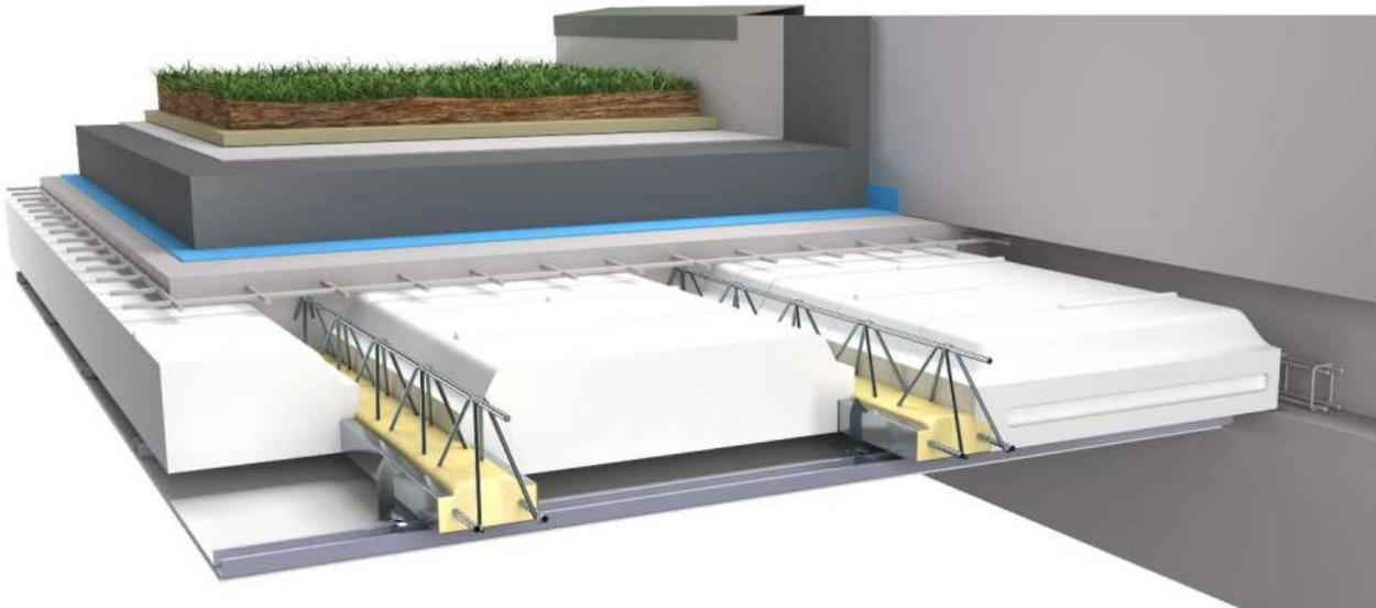
Mise en œuvre d'un **plancher isolant pour réaliser une toiture terrasse** avec poutrelles préfabriquées isolantes et entrevous en polystyrène de type Isoltop ou similaire complété par du béton formant la partie haute des nervures de poutrelles et la table de compression. La mise en œuvre sera conforme aux prescriptions du guide de pose, au plan de pose du fabricant et aux normes en vigueur. L'épaisseur du plancher pourra varier suivant la portée et les charges.
