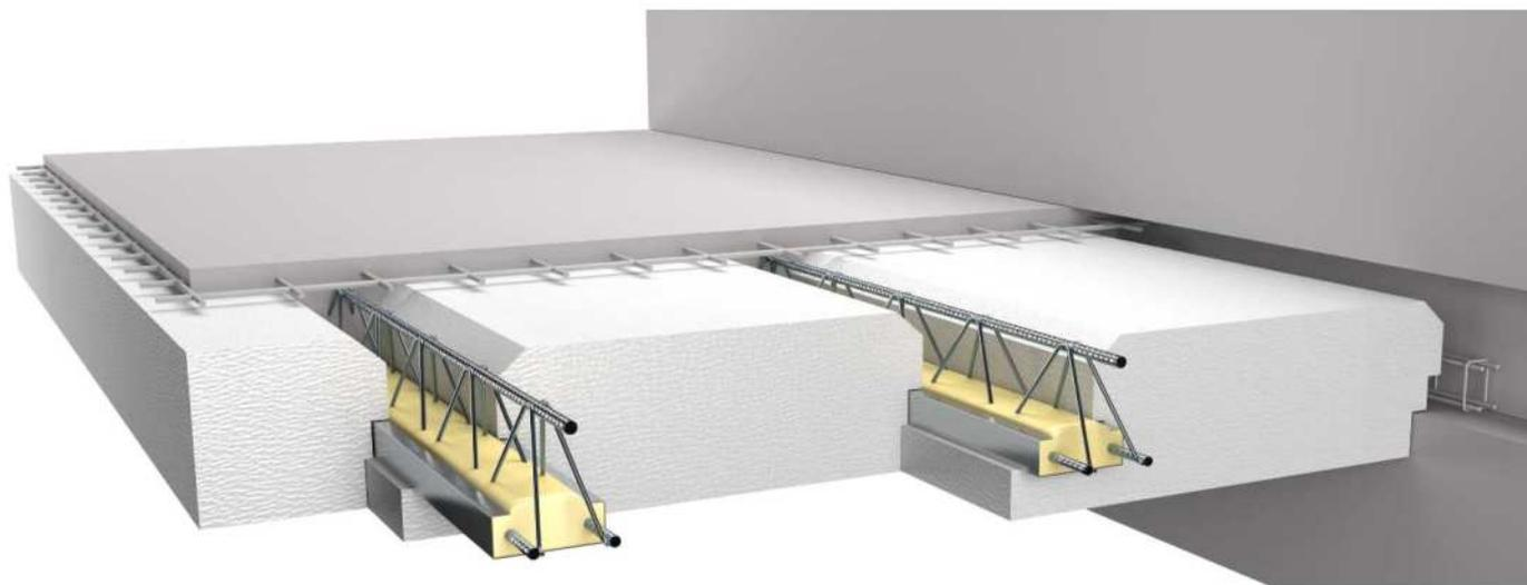
Mise en œuvre d'un **plancher isolant sur vide sanitaire** avec poutrelles préfabriquées isolantes et entrevous en polystyrène de type Isoltop ou similaire complété par du béton formant la partie haute des nervures de poutrelles et la table de compression. La mise en œuvre sera conforme aux prescriptions du guide de pose, au plan de pose du fabricant et aux normes en vigueur. L'épaisseur du plancher pourra varier suivant la portée et les charges.
