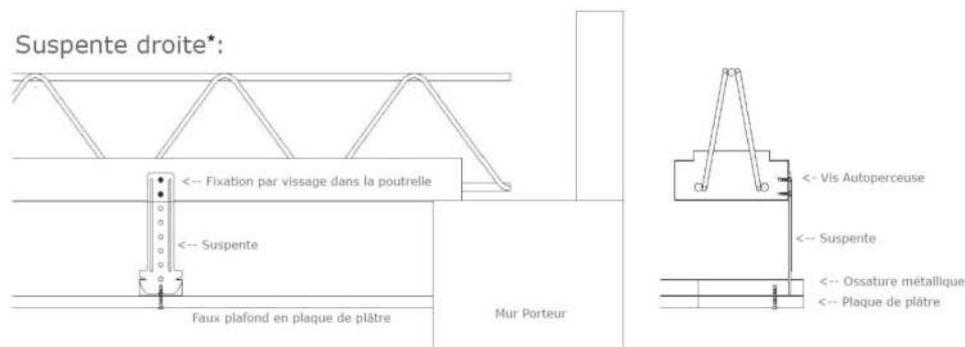
\*Ce type de suspente ne peut être mis en place que si la face latérale du talon des poutrelles PSI reste apparente sur une hauteur de 2,5cm après mise en œuvre du plancher.
