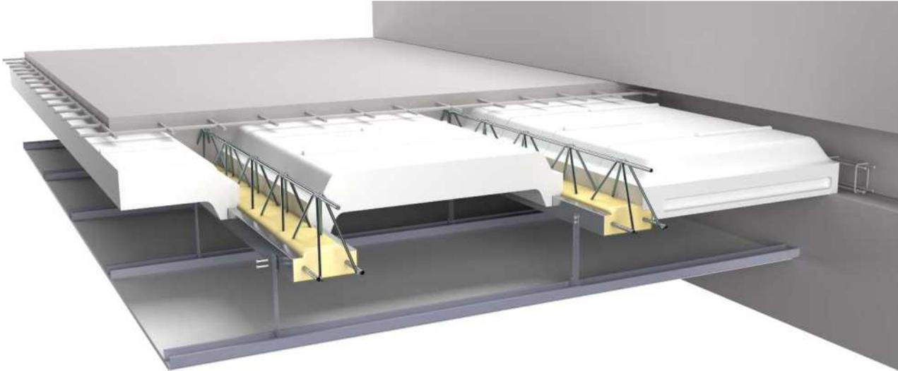
Mise en œuvre d'un **plancher intermédiaire** avec poutrelles préfabriquées ultra légères et entrevous de coffrage de type Isoltop ou similaire, complété par du béton sur chantier remplissant les nervures des poutrelles et la table de compression. La mise en œuvre sera conforme aux prescriptions du guide de pose, au plan de pose du fabricant et aux normes en vigueur. L'épaisseur du plancher pourra varier suivant la portée et les charges.
