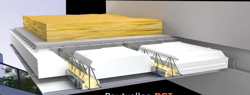
Plancher de combles
