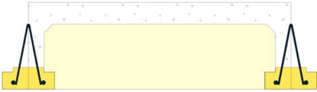
Montage Entrevous Polystyrène
