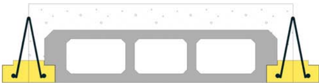
Montage Entrevous Béton
