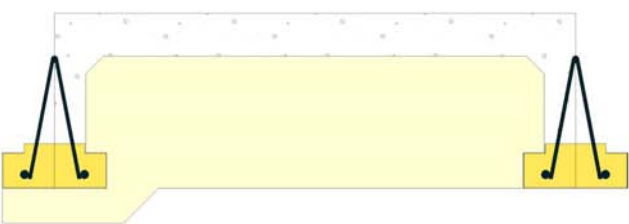
Montage Entrevous PSE avec languette
