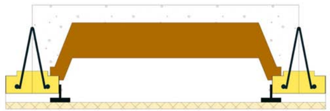
Montage Entrevous Bois + plafond plâtre
