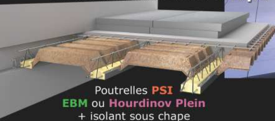
Plancher de Sous-sol avec isolant sous chape
