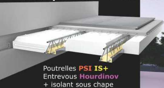
Plancher de Vide Sanitaire avec plancher chauffant
